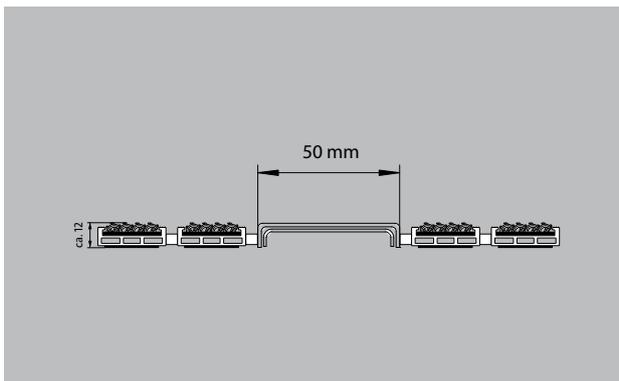
Perfil de Acero inoxidable de alta calidad con la opción de inserir mediante láser el texto del logo deseado para luego incorporar en los Sistemas de Alfombras de Entrada emco. Su posicionamiento y tipografía libres en su diseño.
