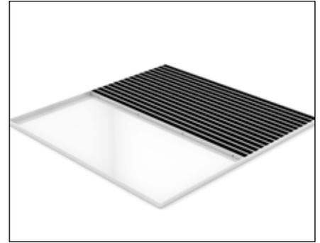
Die Wannen vom Typ 55xx schließen in Breite, Tiefe und Höhe bündig mit der Eingangsmatte ab. Die Wanne erfüllt dabei die Funktion eines im Boden ausgespartem Mattenbettes mit Rahmen. Diese Wannen erleichtern den Einbau im Estrich erheblich. Zudem lässt sich die Wanne einfach reinigen und schützt dadurch nachgelagerte Böden ebenso wie den Unterboden.
