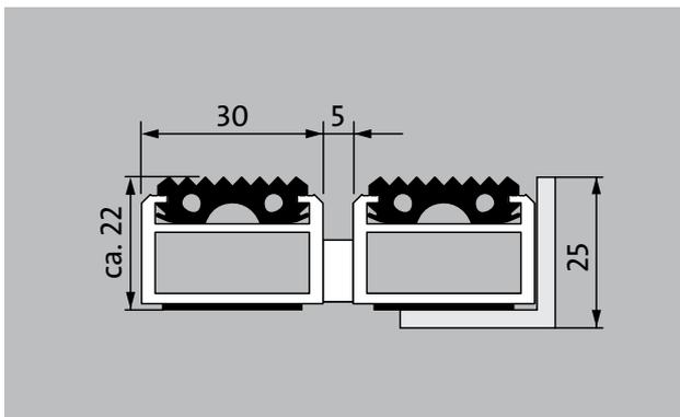
La Alfombra de Entrada original con la inserción de caucho perfilado para eliminar de manera notable la suciedad gruesa. Diseñado óptimamente para edificios expuestos a pisadas extremas.
