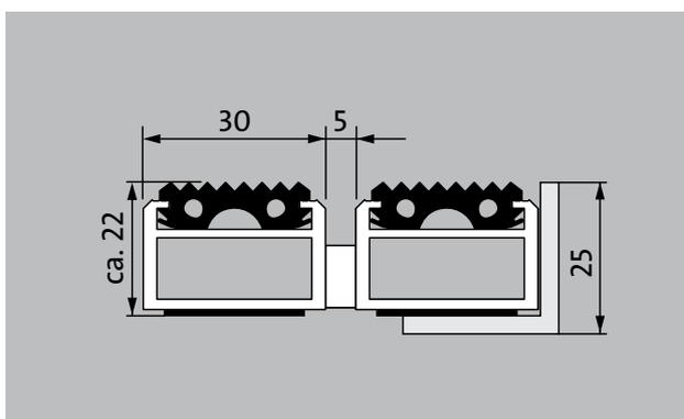
tappeto di ingresso originale con inserto in gomma profilato per rimuovere in modo notevole lo sporco grossolano. Progettato in modo ottimale per edifici esposti a traffico estremo.
