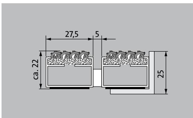
Il tappeto d'ingresso originale con l'inserto a coste in fibra grossa efficace è eccezionalmente resistente all'abrasione e offre la massima stabilità dimensionale. Particolarmente ideale per la raccolta dello sporco fine. Progettato in modo ottimale per edifici esposti a traffico da medio a pesante.
