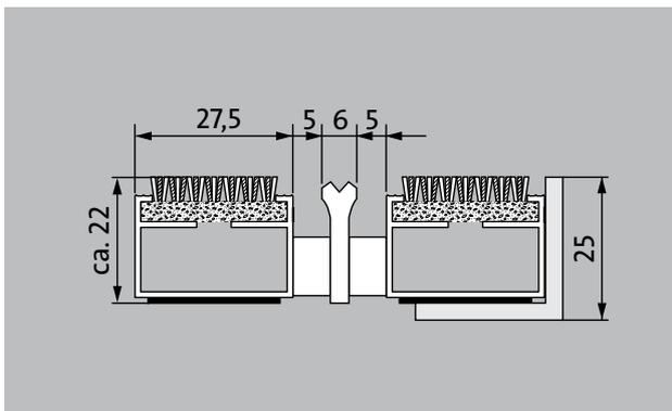
Die Premium-Eingangsmatte mit der besonders anpassungsfähigen Einlage Innova steht für repräsentative Optik und verbessert die Raumakustik. Besonders geeignet für die Aufnahme von Feinschmutz. Das Zusatzprofil bietet einen extra Reinigungseffekt. Optimal für Gebäude mit normaler bis starker Belastung ausgelegt.
