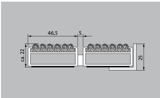
La alfombra de entrada Premium extra ancha y resistente con la inserción Outdoor para una recolección de la suciedad gruesa notablemente profunda. El perfil adicional ofrece un efecto de limpieza extra. Ideal para edificios con cargas extremas.
