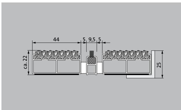
La Alfombra de entrada original de perfil de anchura extra con inserción de fibras gruesas es excepcionalmente resistente a la abrasión y ofrece la máxima estabilidad dimensional. Diseñada para recoger la suciedad fina. El perfil adicional aporta mayor capacidad de limpieza. Diseñado de forma óptima para edificios expuestos a pisadas medias y pesadas.
