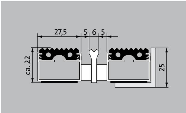
La Alfombra de Entrada original con la inserción de caucho perfilado para eliminar de manera notable la suciedad gruesa. El perfil adicional aporta mayor capacidad de limpieza. Diseñado óptimamente para edificios expuestos a pisadas medias a fuertes.
