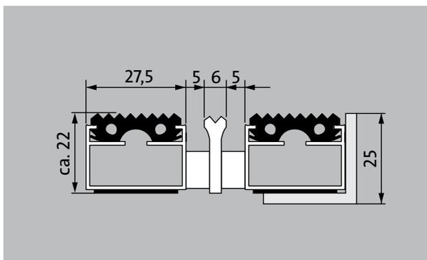
tappeto di ingresso originale con inserto in gomma profilato per rimuovere in modo notevole lo sporco grossolano. Il profilo aggiuntivo offre ancora più potere pulente. Progettato in modo ottimale per edifici esposti a traffico da medio a pesante.
