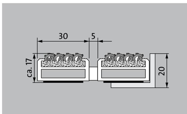
Il tappeto d'ingresso originale con l'inserto a coste in fibra grossa efficace è eccezionalmente resistente all'abrasione e offre la massima stabilità dimensionale. Particolarmente ideale per la raccolta dello sporco fine. Progettato in modo ottimale per edifici esposti a traffico estremo.
