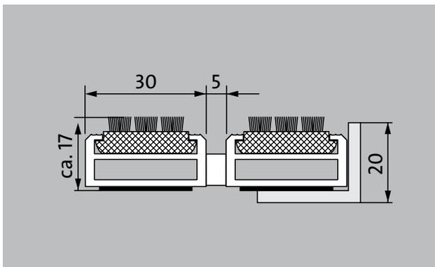
Die Original-Eingangsmatte mit der witterungsbeständigen Einlage Cassettenbürste für spürbar gründlichen Grobschmutzabrieb ist mit parallel angeordneten Borstenbündeln bestückt. Optimal für Gebäude mit extremer Belastung ausgelegt.
