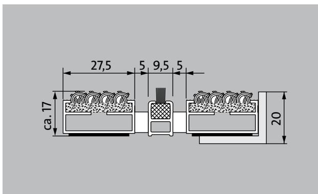
La Alfombra de Entrada original con la inserción de fibras gruesas es adecuada para resistir la abrasión y ofrece máxima estabilidad dimensional. Diseñada para recoger la suciedad fina. El perfil adicional aporta mayor capacidad de limpieza. Diseñado óptimamente para edificios expuestos a pisadas medias a fuertes.
