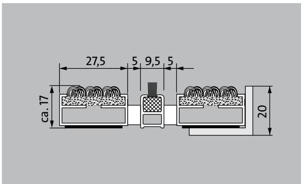
Die Premium-Eingangsmatte mit der robusten Einlage Care ist äußerst abriebfest und die erste Wahl, wenn es um effektive Reduzierung von Feinschmutz geht. Das Zusatzprofil bietet einen extra Reinigungseffekt. Optimal für Gebäude mit normaler bis starker Belastung ausgelegt.
