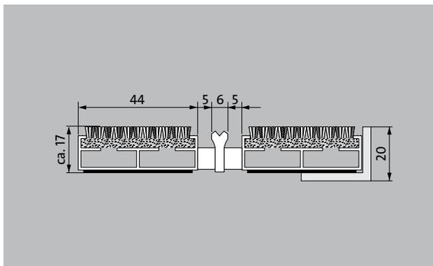
La Alfombra de Entrada Premium de perfil de anchura extra con la inserción Conform se compone de materiales reciclados siendo el complemento perfecto para zonas de madera y utilizable en gran variedad de entornos. Diseñada para recoger la suciedad fina. Diseñado óptimamente para edificios expuestos a pisadas extremas.
