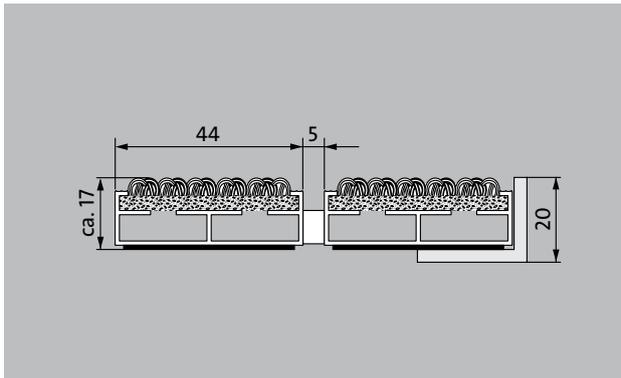
Il tappeto d'ingresso Premium extra largo con il robusto inserto Care è eccezionalmente resistente all'abrasione e la scelta numero uno per la riduzione efficace dello sporco fine. Progettato in modo ottimale per edifici esposti a traffico da medio a pesante..
