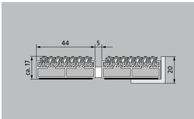
Die extra breite Original-Eingangsmatte mit der erfolgreichen Einlage Grobfaserrips ist äußerst abriebfest und bietet größte Formstabilität. Besonders geeignet für die Aufnahme von Feinschmutz. Optimal für Gebäude mit normaler bis starker Belastung ausgelegt.
