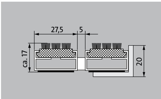
Die Original-Eingangsmatte mit der witterungsbeständigen Einlage Cassettenbürste für spürbar gründlichen Grobschmutzabrieb ist mit parallel angeordneten Borstenbündeln bestückt. Optimal für Gebäude mit normaler bis starker Belastung ausgelegt.
