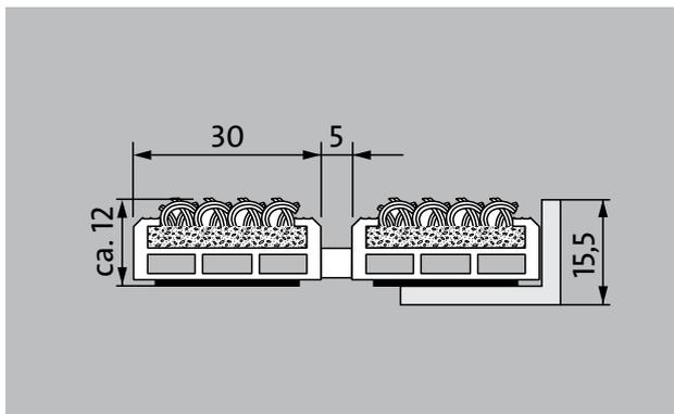
Die Original-Eingangsmatte mit der erfolgreichen Einlage Grobfaserrips ist äußerst abriebfest und bietet größte Formstabilität. Besonders geeignet für die Aufnahme von Feinschmutz. Optimal für Gebäude mit normal bis starker Belastung ausgelegt.
