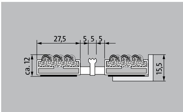
Die beständige Premium-Eingangsmatte mit der Einlage Outdoor für spürbar gründlichen Grobschmutzabrieb. Das Zusatzprofil bietet einen extra Reinigungseffekt. Optimal für Gebäude mit normaler bis starker Belastung ausgelegt.
