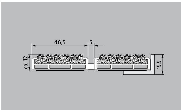
La alfombra de entrada Premium extra ancha y resistente al clima con inserción exterior para una abrasión sensible y profunda de la suciedad gruesa. El perfil adicional ofrece un efecto de limpieza adicional. Ideal para edificios con una carga normal a fuerte.
