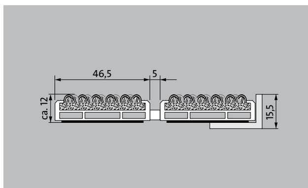
Il tappeto tecnico Premium extra largo e resistente alle intemperie con l'inserto Outdoor per la rimozione visibilmente accurata di sporco grossolano. Ideale per edifici con carichi normali o pesanti.
