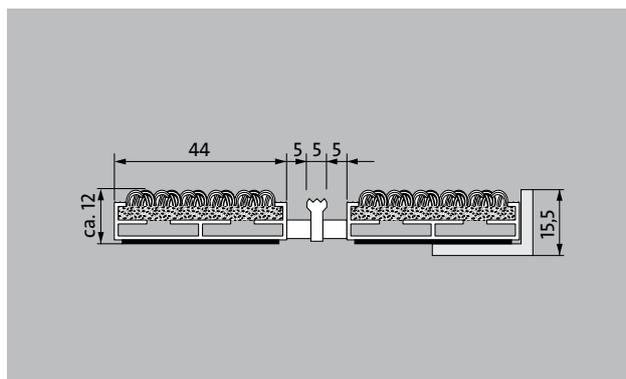
Il tappeto d'ingresso Premium extra largo con il robusto inserto Care è eccezionalmente resistente all'abrasione e la scelta numero uno per la riduzione efficace dello sporco fine. Il profilo aggiuntivo offre ancora più potere pulente. Progettato in modo ottimale per edifici esposti a traffico da medio a pesante.
