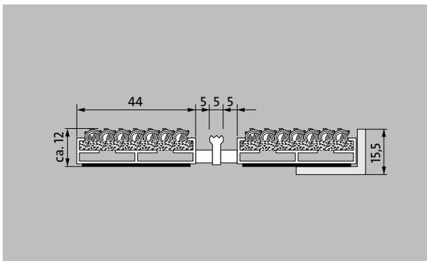
Die extra breite Original-Eingangsmatte mit der erfolgreichen Einlage Grobfaserrips ist äußerst abriebfest und bietet größte Formstabilität. Besonders geeignet für die Aufnahme von Feinschmutz. Das Zusatzprofil bietet einen extra Reinigungseffekt. Optimal für Gebäude mit normaler bis starker Belastung ausgelegt.
