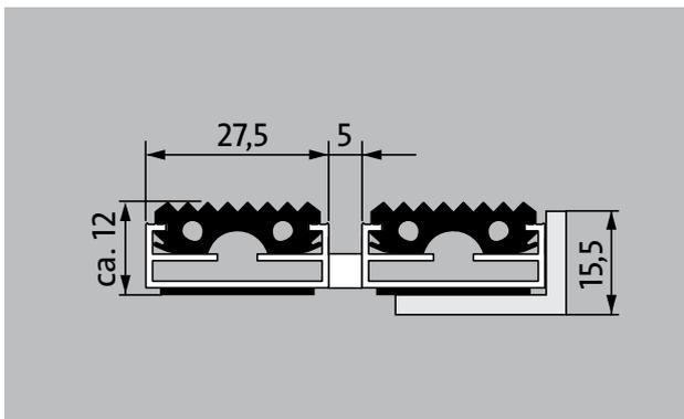
Die Original-Eingangsmatte mit der profilierten Einlage Gummi für spürbar gründlichen Grobschmutzabrieb. Optimal für Gebäude mit normaler bis starker Belastung ausgelegt.
