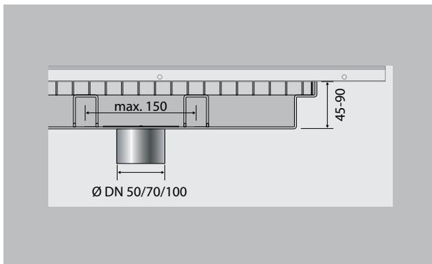
Um dem erhöhten Schmutzanfall in stark frequentierten Eingangsbereichen souverän zu begegnen, sind emco Schmutzfangwannen eine Notwendigkeit. Mit den Eingangsmatten emco MARSCHALL, emco Plaza in Verbindung mit einem Gitterrost und enger zusammenstehenden Unterstützungsprofilen (nicht in Kombination mit Kratzkante oder Bürstenleiste) bilden sie eine starke Einheit, die in Reinigungswirkung, schweren Lasten und Praktikabilität nicht zu überbieten ist.
